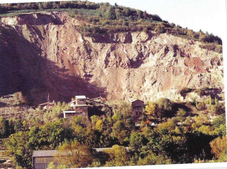
..... ••••• La carrière Haute-Schleif de Hersbach, exploitée en gradins (en haut). Avant 2008, elle était creusée horizontalement.
